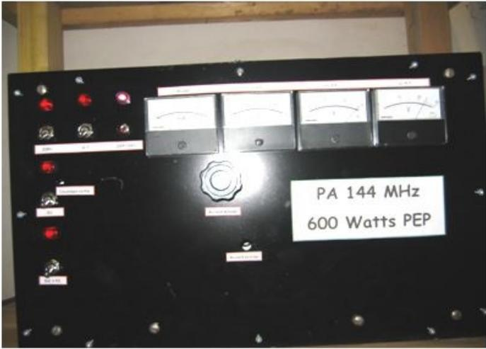
Une réalisation de Denis F6DBA : amplificateur 600 watts PEP sur 144MHz
