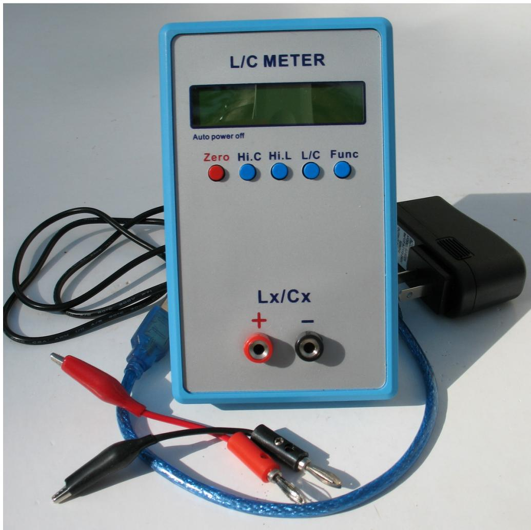
Parmi les appareils indispensables au radioamateur, il y a celui qui permet de mesurer les capacitances
